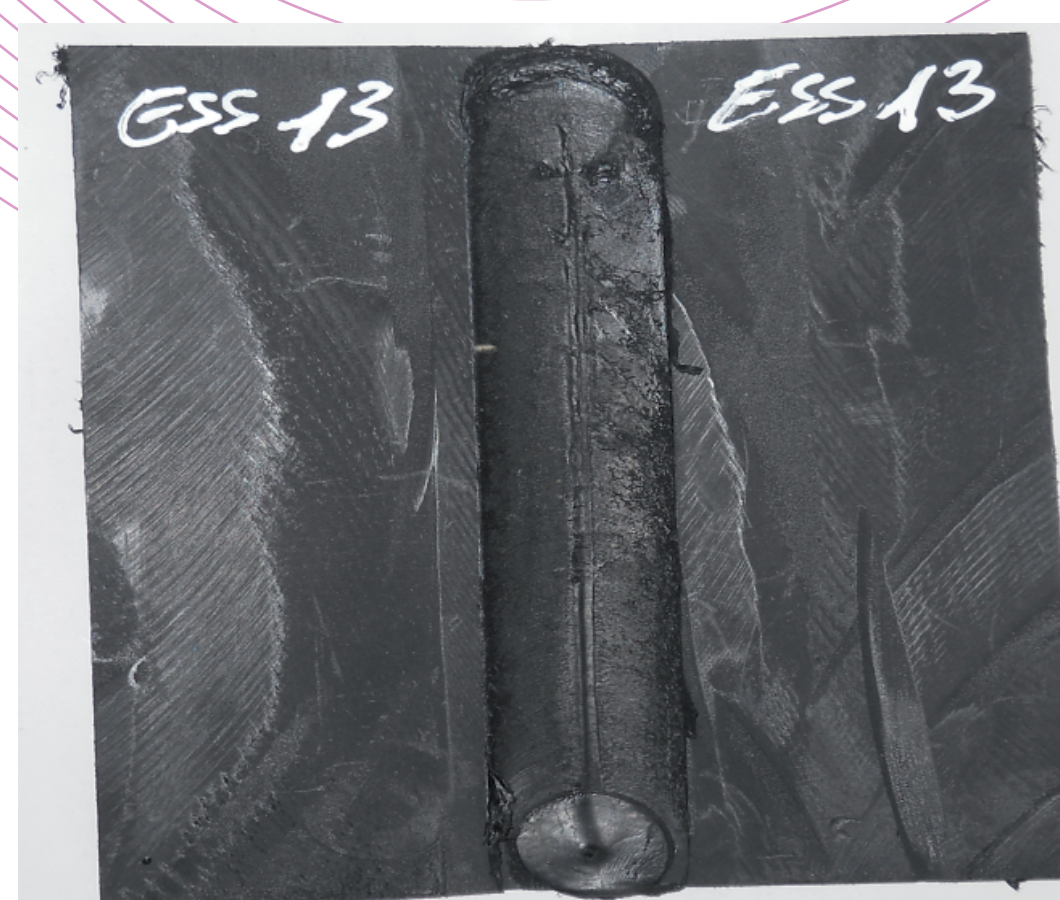
Image de Soudage par FSW
