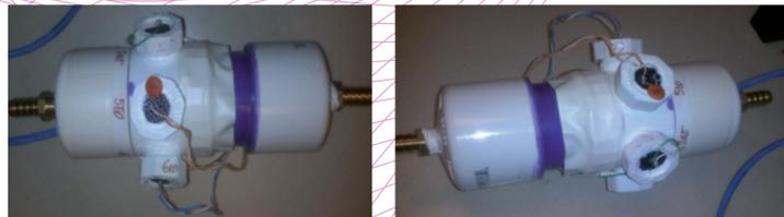
Figures 2 et 3 montrant les détails de la chambre d'analyse de l'instrument avec la position des différents émetteurs/capteurs. Le fluide est injecté du coté gauche de la chambre, est homogénéisé dans la première section de la chambre avant de passer devant les capteurs pour analyse pour être ensuite évacué du coté droit. Le fluide ainsi récupéré n'aura subi aucune transformation (analyse non destructive).
