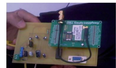
Figure 3. Carte d'adaptation TTL/RS232 + module GSM TM2 + Antenne
