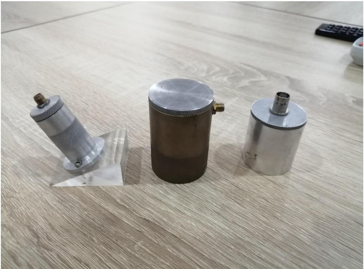
Figure 1: Capteurs ultrasonores appliqués au CND
